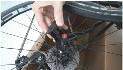
從隨車盒中取出快拆保護裝置，裝在後輪快拆頭上。
