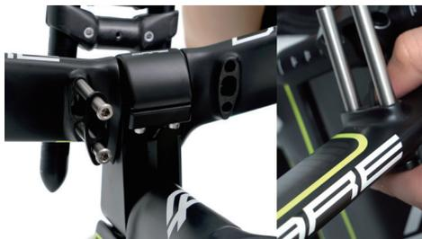
將 F1 螺柱穿過 C3 底板 (注意底板有圓形凹槽部分朝下)，從把手下方穿出 (注意 C3 板形狀有方向性，較寬的朝前)。
