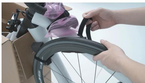
手握前輪，拆除前輪固定魔鬼氈帶，取下前輪，將前輪妥善放置一旁。
