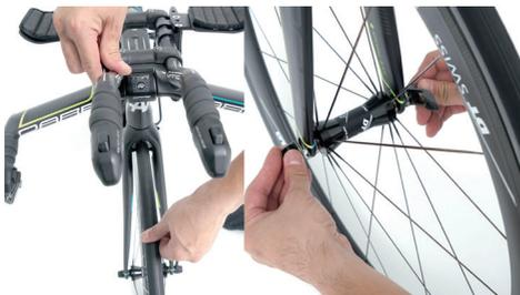
從配件盒中取出 Q(前輪快拆)，快拆柄在車體左側，組上前輪。(前輪組裝方式請參考第 24 頁)
