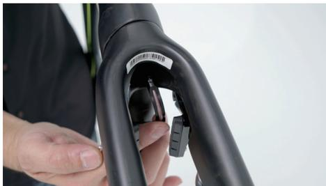
組裝前輪前，先檢查前叉下方 G7(前煞車拉桿) 是否因運送而彈出，請先將拉桿上方推回前叉豎管內，避免騎乘時干涉前輪。
