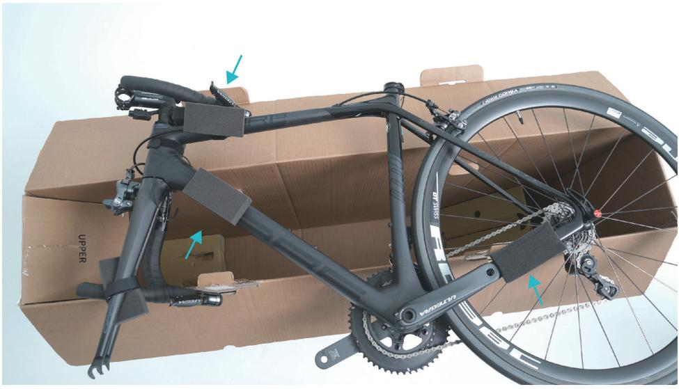
為方便固定前輪，請將車子從箱子取出，橫躺在車箱上面，車體左側朝上，並準備另外三組泡棉塊如圖示在車架的上管、下管及後下叉三個位置上。
