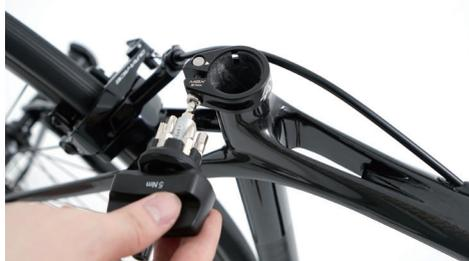
取下立管上方末端保護套，將座管夾具螺絲逆時針方向鬆開。
