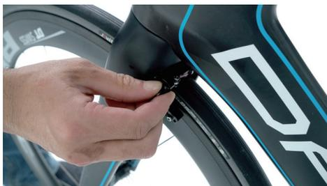
將 G7 左側快拆旋鈕勾入左前煞車溝中，抬起車體轉動前輪，試壓煞車手柄感受煞車力道是否與後輪相同，制動效果是否顯著。
