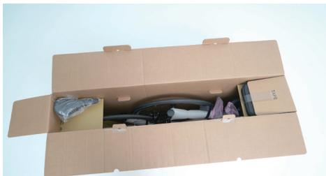
打開箱子，可見已組裝 85% 的成車組（已安裝後輪及相關組配件），需要組裝的是前輪、座管、座墊、及車手把總成，一盒隨車工具箱，盒中的內容物有補修吊耳組及螺絲、前輪快拆、組配相關零件、碳纖維磨砂膏、5NM 扭力扳手組、反光照組、隨車說明書、產品保固卡及加購商品 (DI2 配備則還有相關充電設備)。
