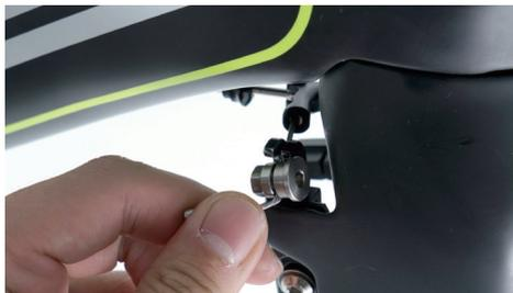
將右邊前煞車扣，勾入右煞車溝槽中。
