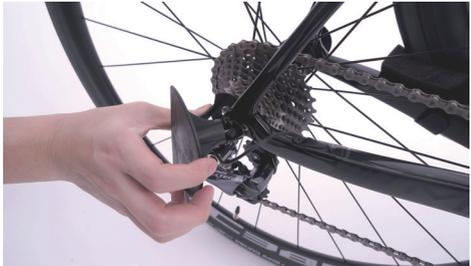
從隨車盒中取出後變速保護裝置，裝置在後輪後變處。
