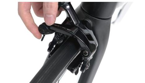
關閉 SHIMANO 夾器上的放鬆快拆桿，確認煞車回復。更多煞車裝置調整請參考 DARE 公路車詳細說明書的『煞車裝置』單元。
