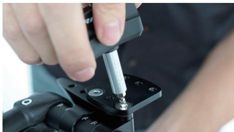
拿 M3 和 M4 扭力扳手將 B7/B8 延伸片上四個螺絲以 5Nm 鎖緊。
