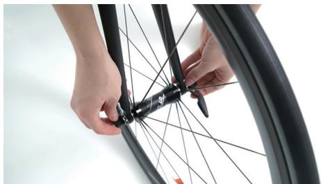
確認中心無誤後，直接旋轉快拆把手到完全鎖死。
