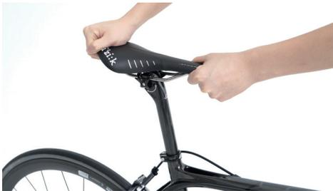
檢查座管坐墊鎖固是否牢固，請用力搬動座管和扭力檢查。
