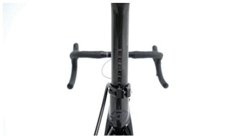
將座管插入車架立管內，觀察刻度到您的所需高度。
