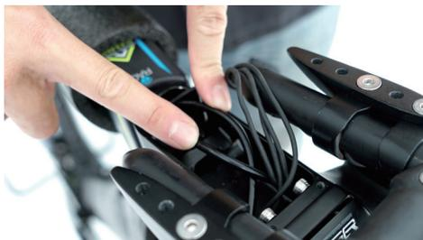
取出 I1 工具，並將兩條煞車線輕推入龍頭前端，電子變速集線器先不用放入龍頭，接著休息把墊塊調整與安裝時還需要調整。
