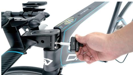
龍頭輕輕轉向右側，確保車手把和車輪持續維持在中心成一直線，將龍頭側邊的固定螺絲用 M4 板手鎖固至 5Nm。
