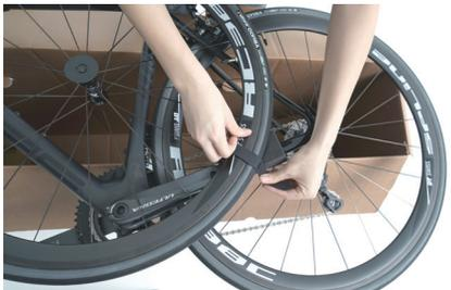
將前輪放置在泡棉塊上 (有花鼓保護片的那一面朝上) 用魔鬼氈帶固定車輪及車架。
