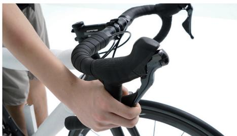
安裝完前輪並鎖上夾器快拆後，多次按壓前煞車檢查是否壓點和後煞車感受一樣，並感受多次按壓是否穩定且牢固。
