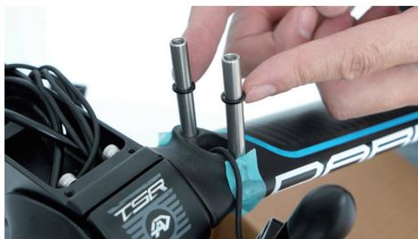
在組裝墊高塊之前，每根螺柱先套上一個 C1 墊圈 (1.5mm)。
