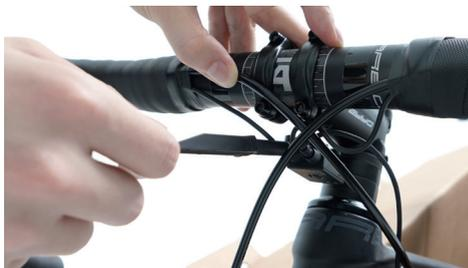
系統是電子變速的話，請使用隨車附的 PLUG TOOL 套筒頭端將電線接上集線器，注意需聽到”喀”的接合聲才算完成。
