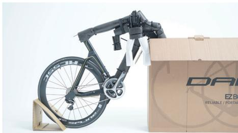
將整車跨放在 EZBOX 車箱邊緣，利用三角車體固定座固定後輪，方便操作單人操作組裝。
