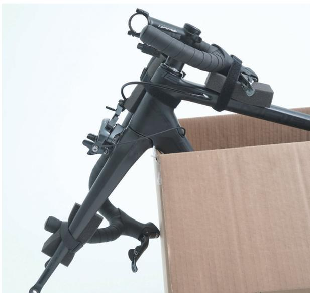
依圖示位置將泡棉塊放入車架和車把手之間，再用固定帶綁定穩固
