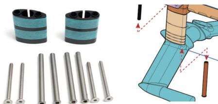
堆疊完成後測量墊塊總高度，再次確認螺絲和螺柱的選擇是否符合上頁螺絲長度搭配表的要求 (例如 55mm 的墊塊高，要搭配 F1 螺柱和 E6 螺絲來組裝)。
