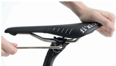
坐墊調整：使用 4 號六角板手鬆開 DARE 單軸坐墊夾，您即可調整適合的坐墊位置及角度，但注意坐墊在最終必須是呈現水平狀態。
