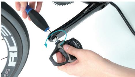
先用手將踏板旋入曲柄 3 圈，然後使用踏板扳手從踏板軸心或是使用 6 號六角板手從踏板反方向將踏板鎖緊。（10Nm）
