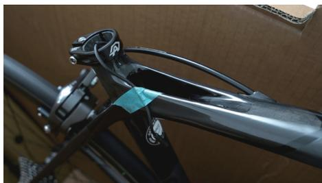
使用膠帶將電線黏貼在車架上，避免運送過程中電線掉入立管中。
