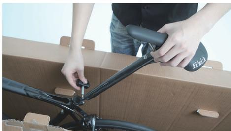
使用 4 號板手將座管從車體抽出，再將座管束微微鎖緊在車架上。
