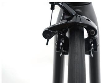
1. 檢查輪圈是否在煞車夾器和前叉正中央
