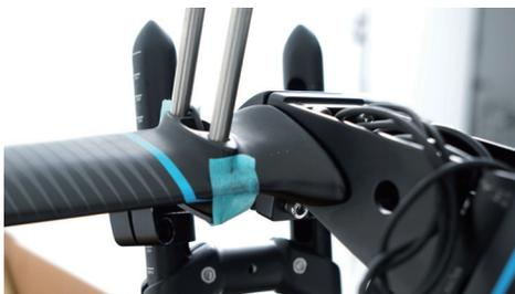
用紙膠帶貼合固定底板，防止後續組裝墊塊時掉落。
