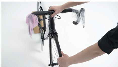
一手將車架拿起，快拆把手在車架左側的方向（在鏈條的相反側）將前輪放入前叉，微調快拆軸左右讓叉腳進入快拆軸心。更多快拆說明請參考 DTSWISS 輪組官方資料。
