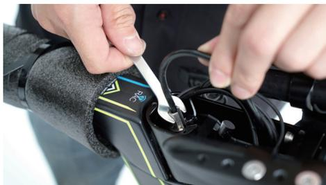
利用 M1 板手順時針鎖緊 I2 螺絲，鎖緊過程另一隻手將煞車線抬起置中不要碰到 I2 螺絲。
