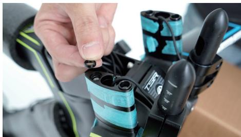
在墊高塊上面放置 C2 墊圈 (3mm) 在凹槽上。
