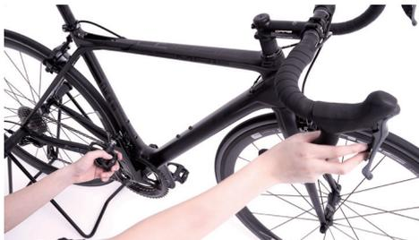
切換所有檔位確認變速順暢，且後變速器到最大盤，鏈條運轉不會掉落到大飛輪後面。
