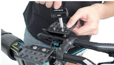
決定位置後，輕鎖螺絲到 B5/B6 不晃動即可 (約 1Nm)。切勿鎖死，以方便稍後的休息把調整。
