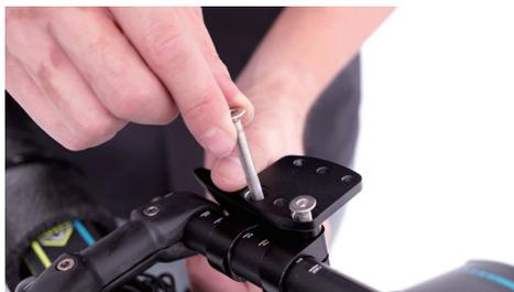
鬆開螺絲取下 B5/B6，將 B7/B8（字母朝下，R 組裝在右方，L 組裝在左方）放置在 B9/B10 上，再將卸下的螺絲穿過 B7/B8 後鎖上。
