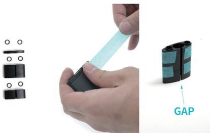
預先組裝您的墊高塊 (圖中以 55mm 為例)，注意墊高塊之間的圓形凹槽孔，每個孔必須裝上一個 C2 墊片 (3mm)，並使用隨車附贈紙膠帶將堆疊好的墊高塊貼起來固定，注意膠帶不要蓋住內側線溝槽。
