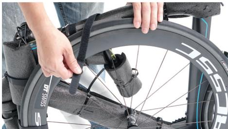
將三鐵整車從 EZBOX 中取出，拆除固定前輪的三個魔鬼氈束帶和泡棉後，將前輪先取下妥善放回箱中。
