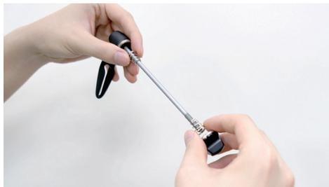
將前輪快拆從隨車工具箱取出，卸下螺母並抽出其中的一個彈簧。
