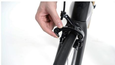
稍微旋緊快拆，確認輪圈和輪胎有在兩叉腿的中央處。
