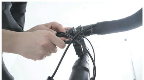
如果您的系統是電子變速系統，請在取下車手把前，利用專門工具將三條電線從集線器上拔下，切勿直接拉扯電線造成損壞。
