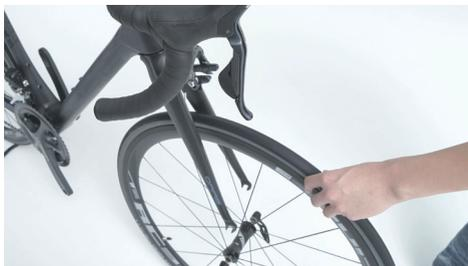
轉鬆前輪快拆，將煞車快拆打開，將前輪取下。
