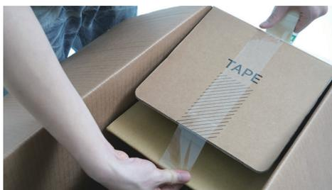
將箱子側邊蓋上工具盒，並用膠帶與下方車體固定座黏貼固定，避免工具盒在運送過程中滑落。
