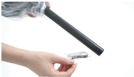
確認後，取出座管，下半部塗上少量碳纖維止滑劑，立管內部和夾具鎖固也處塗上。
