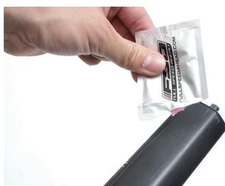
座管插入車架中的部分塗上少量 P (碳纖維止滑劑)，車架立管內部和座管夾鎖固接觸面也塗上少許，確保座管的鎖固夾持力。
