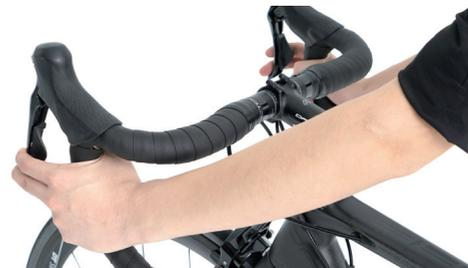
把手調整：跨站在車子上，調整適合的手把角度，通常握把上方區域會趨近水平或略向下。並用扭力板手鎖緊至正確扭力值 5Nm。
