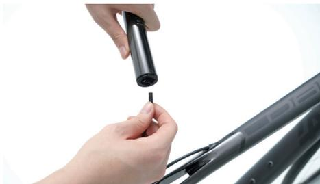
插入座管前，連結立管電線，用力發出 " 喀 " 的固定聲。詳細電子走線系統資訊請參考 SHIMANO 官方資料。
