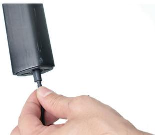
確認無誤後，將電線插到坐管底端接頭，聽到”喀”的接合聲，隨意按一下把手上的變速按鈕，確認電子變速系統是否可以作動(若無法作動請聯繫 DARE 客服人員)。
