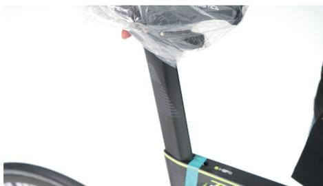
從後輪上方固定座取下座管坐墊組，插入車架立管同時確認是否在無施壓的狀況下也能夠輕鬆插入。
