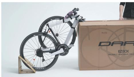
將前叉跨過 EZBOX 側邊放置，利用 EZBOX 當自行車支撐架，方便後續組車操作，後輪建議使用坊間車架固定架，如果沒有，可以先用 EZBOX 的車體固定座，但注意它並不是相當穩固的輪子固定座。
