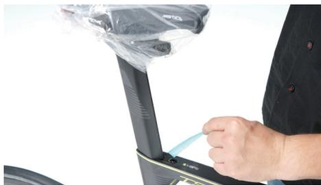
將座管插到您需要的深度後，同時撕除固定膠帶。若座管無法順利插入請勿用力將座管插入車架中，請先試著稍微搖晃座管再試著重新插入，若還是無法順利插入車架中，請聯繫 DARE 客服人員。
