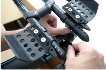
一手將龍頭中電子走線輕拉出，另一手將外露在疊高塊的電線塞入疊高塊溝槽內。
