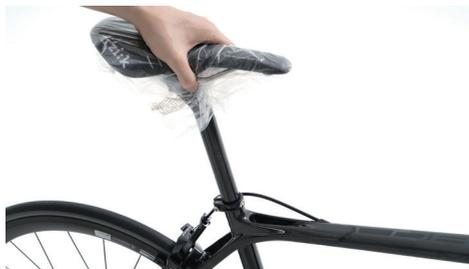
從後輪上方固定座取下座管坐墊組，插入立管確認是否在無施壓的狀況下能夠輕鬆插入。若座管無法順利插入請勿用力將座管插入車架中，並聯繫 DARE 客服人員。
