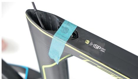
將夾具推進車架座管溝槽，用紙膠帶固定，以利後續操作。
