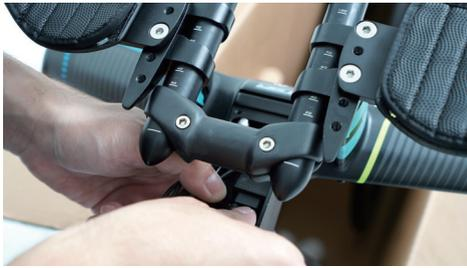
調整休息墊寬度完畢且確認休息把位置無誤，並確認疊高塊溝槽沒有露出電線後，將電子集線器塞回龍頭內。
