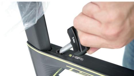
請用 M4 板手，鎖緊 L1 座管夾至 5Nm。
