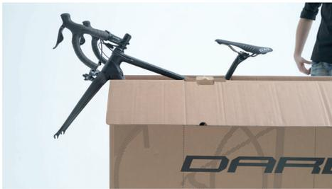
將車子後輪放入 EZBOX 中，用三角固定塊固定住，前叉跨坐在車箱邊緣。
